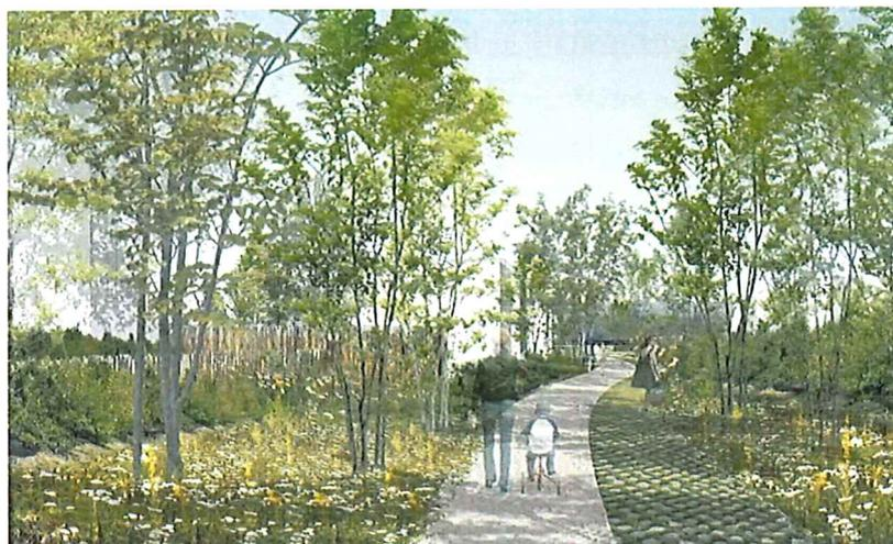
La rue principale et les ruelles seront traitées en enrobé, les trottoirs en béton. La promenade sera une chaussée en revêtement perméable du type dalles alvéolaires / pavés drainants et en béton ou gravette, les stationnements le long des voies seront également perméables du type dalles alvéolaires.
